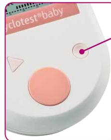
Bei der ersten Inbetriebnahme zum Zyklusstart und zu jedem weiteren Beginn einer neuen Zyklus-Messreihe wird die kleine runde Starttaste benötigt.
